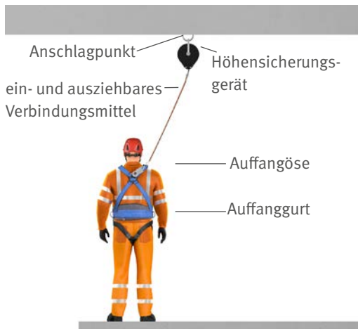
Abb. 5.2 3 Auffangsystem mit Höhsicherungsgerät
