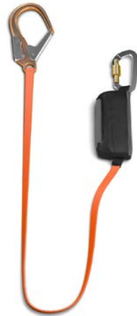
Abb. 5.2 1 Auffangsystem mit Falldämpfer: Der Auffanggurt wird über ein Verbindungsmittel und einem Falldämpfer mit einem Anschlagpunkt am Mast verbunden. Der Anschlagpunkt liegt möglichst oberhalb.
